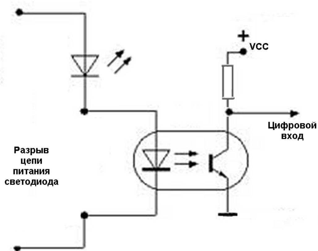
Первый эксперимент: подключение датчика к маршрутизатору
